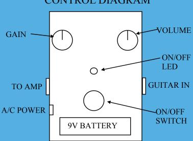
**GAIN:** CONTROLS A WIDE GAIN RANGE **VOLUME:** CONTROLS THE VOLUME MIX
