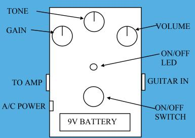
**GAIN:** CONTROLS A WIDE GAIN RANGE **VOLUME:** CONTROLS THE VOLUME MIX
